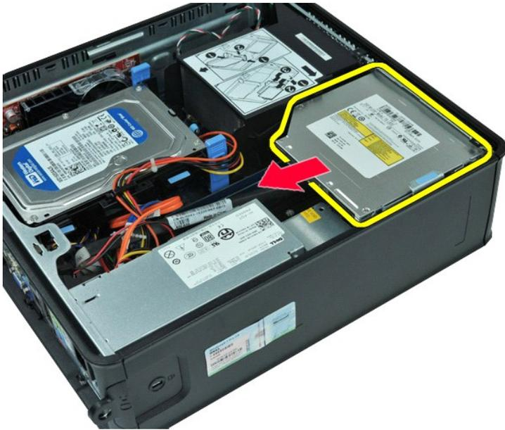
5. Приподнимите оптический дисковод и извлеките его из компьютера.
