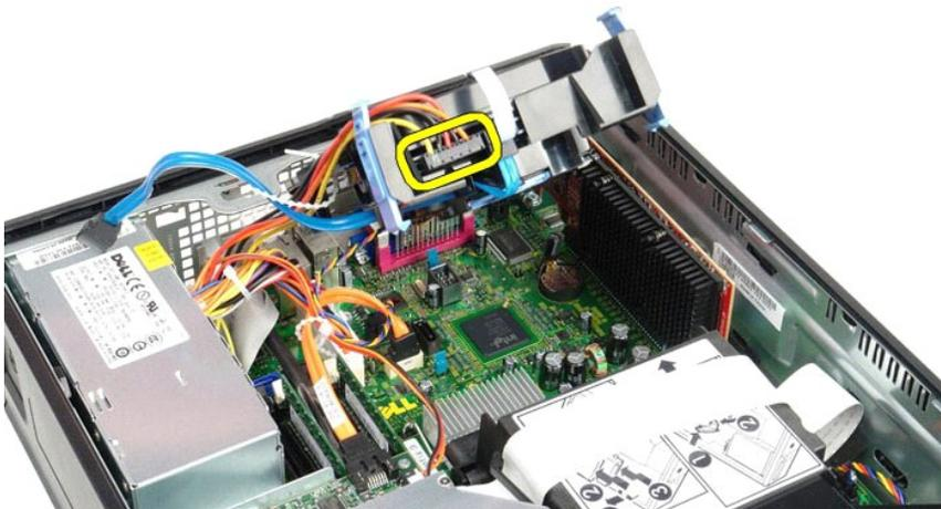
6. Отсоедините кабель вентилятора жесткого диска.
