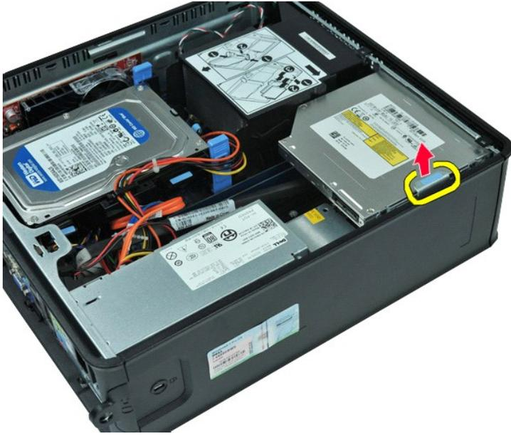
4. Поднимите защелку дисковод и сдвиньте оптический дисковод в направлении задней части корпуса компьютера.
