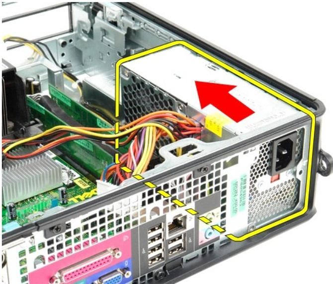
8. Приподнимите блок питания и извлеките его из компьютера.
