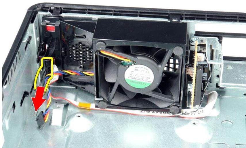
4. Нажмите на фиксатор, чтобы высвободить вентилятор из корпуса компьютера.
