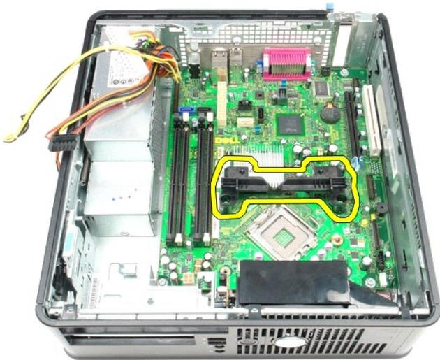
14. Выверните винты, которыми системная плата крепится к корпусу компьютера.
