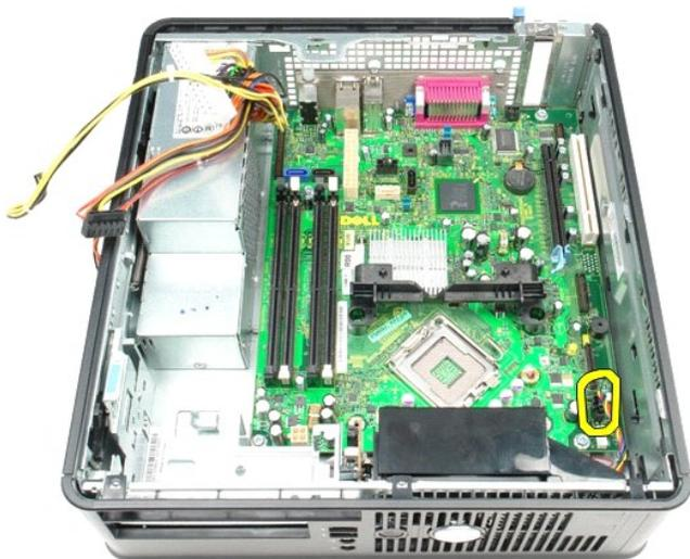
12. Выверните винты, которыми модуль держателя радиатора крепится к системной плате.
