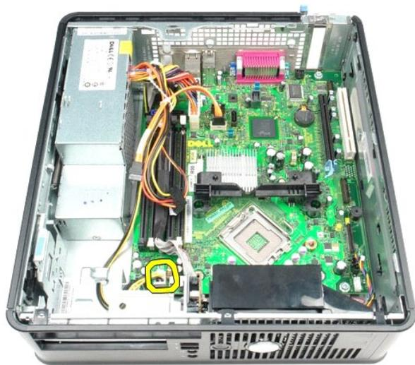
8. Отсоедините от системной платы кабели передачи данных жесткого диска и оптического диска.
