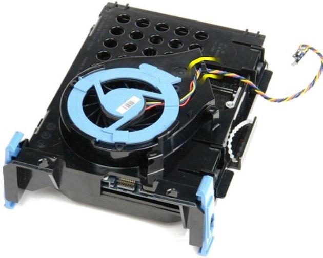
11. Приподнимите синий язычок и поверните его против часовой стрелки, чтобы отсоединить вентилятор жесткого диска от корпуса жесткого диска.
