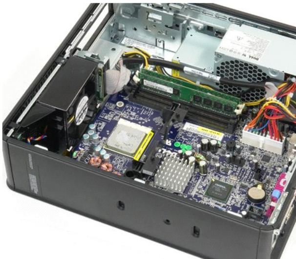
5. Извлеките процессор из разъема на системной плате.
