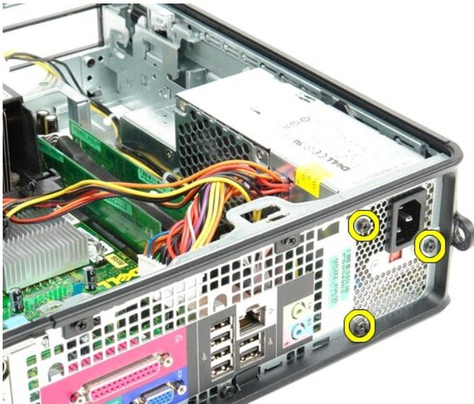
7. Сдвиньте блок питания в сторону задней части компьютера.
