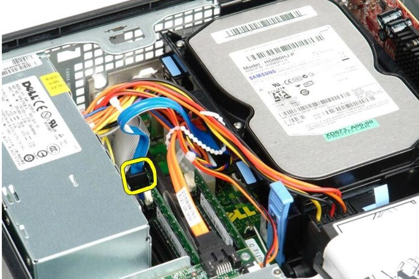
4. Сожмите синие защелки с каждой стороны корпуса диска, а затем сдвиньте корпус диска вверх и извлеките его из компьютера.
