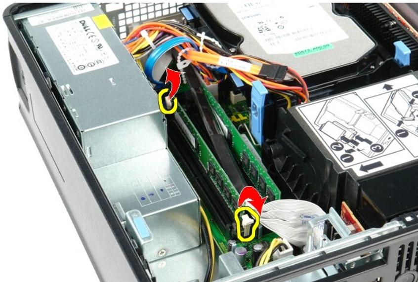
3. Извлеките модуль памяти из разъема на системной плате и выньте его из компьютера.
