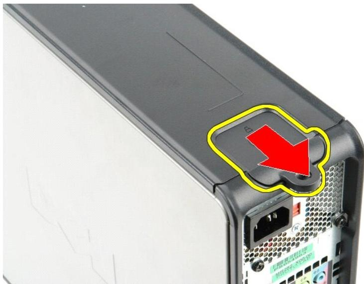
3. Поднимите крышку в верхней части, а затем снимите ее с компьютера.
