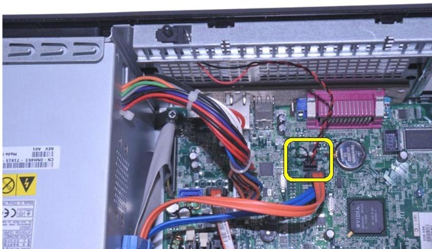
4. Выдвиньте датчик вскрытия корпуса из его гнезда в металлической скобе, надавите на него и извлеките его из компьютера.
