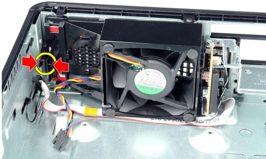
5. Наклоните вентилятор вперед и извлеките его из корпуса компьютера.
