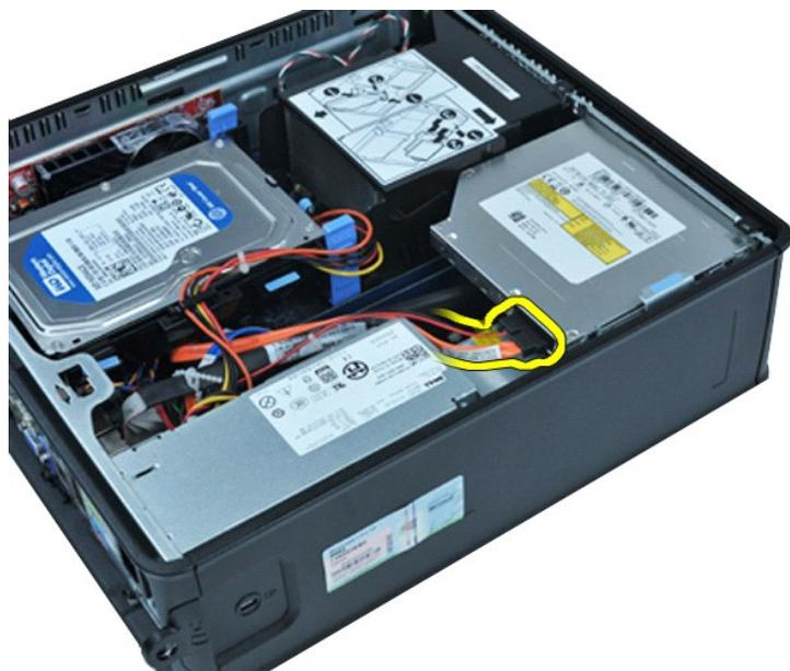
3. Отключите кабель питания сзади оптического дисковода.
