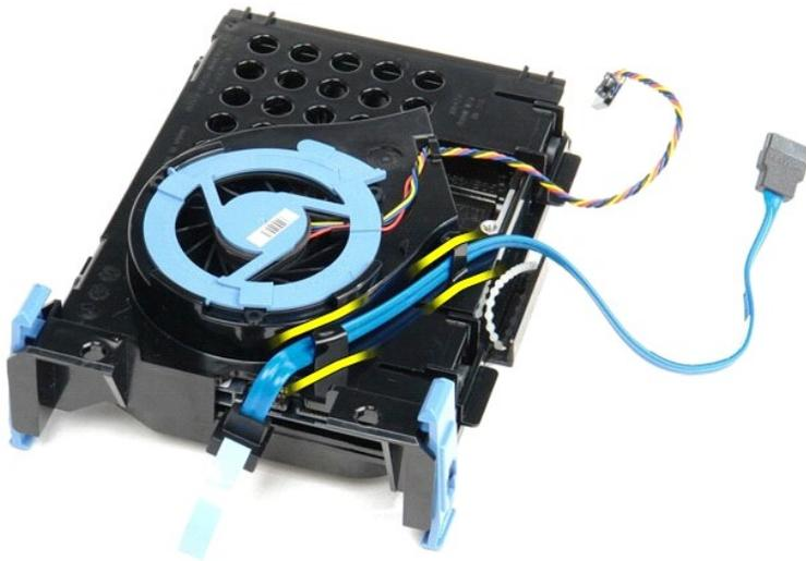
10. Извлеките кабель вентилятора жесткого диска с внешней стороны корпуса диска.
